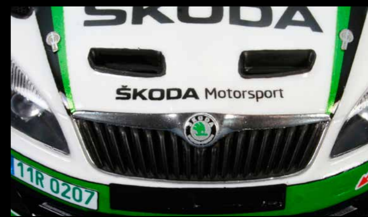
Le dessus de la calandre est également peint en Alclad Chrome. Les attaches de carrosserie sont fournies en photo-découpe.
