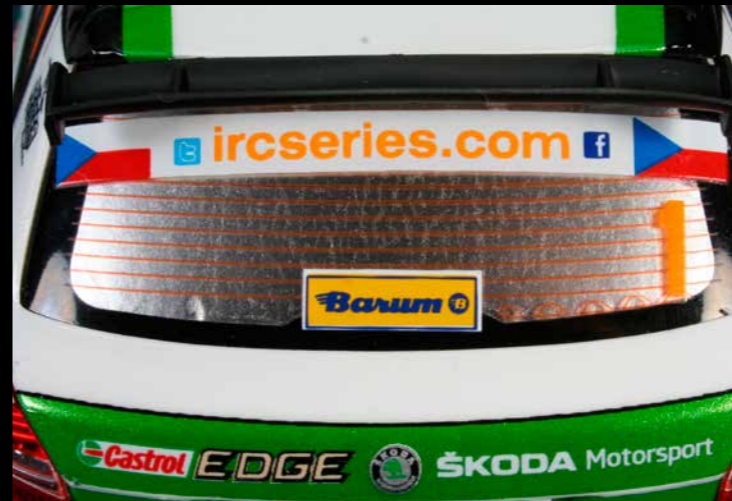
Le circuit de désembuage est imprimé sur la lunette arrière - une première selon l'auteur. Seule la voiture d'Hanninen a un adhésif argenté à l'intérieur de la lunette.
