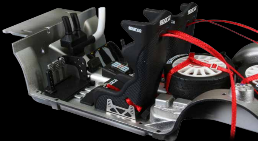
L'habitacle vient se poser sur le châssis et les cloisons latérales ferment l'ensemble. Notez les deux roues de secours à l'arrière.
